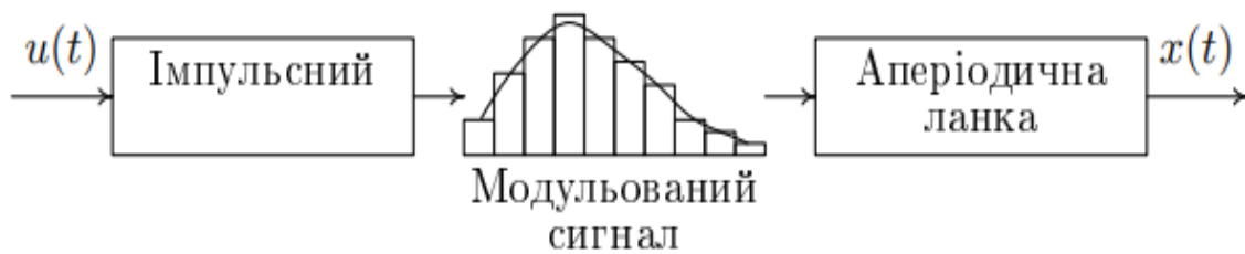
Рисунок 3.8 Схема імпульсного елемента
