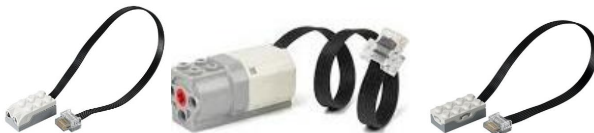
Рис. 2.4. Двигун та датчики нахилу та руху WeDo 2.0
