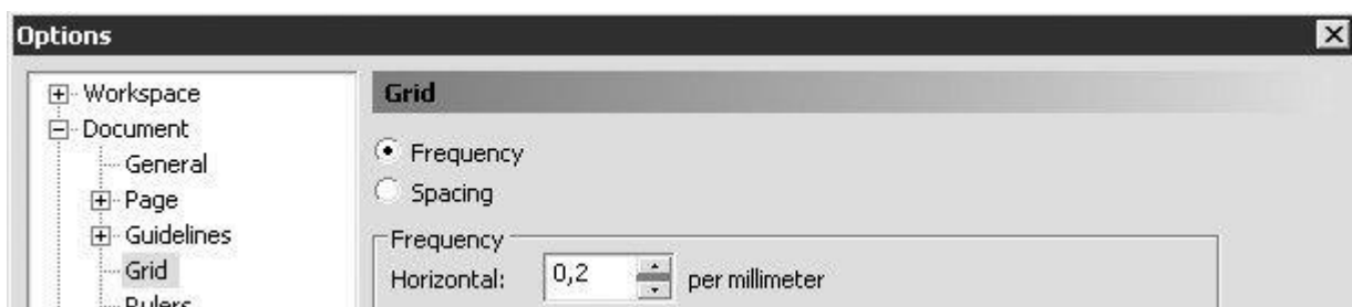
Рис. 3.28. Перемикач, що надає можливість вибрати режим налаштування параметрів сітки
