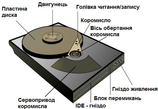
Рис. 3.2. Структура жорсткого диска
