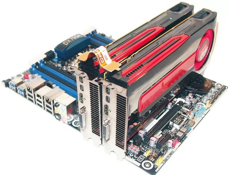
Рис. 5.5. Демонстрація системи CrossFireX від AMD
