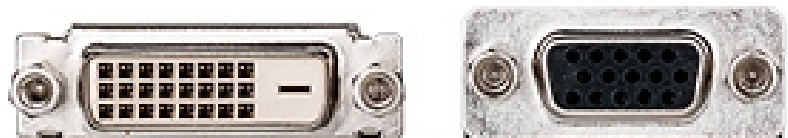
Рис. 5.4. Інтерфейси інтегрованої відеокарти (DVI, VGA)
