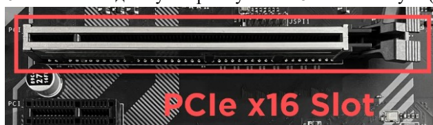
Рис. 5.3. Слот PCI Express x16
