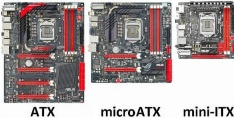
Рис. 6.6. Фізичне співставлення плат АТХ, MicroАТХ, Mini-ITX
