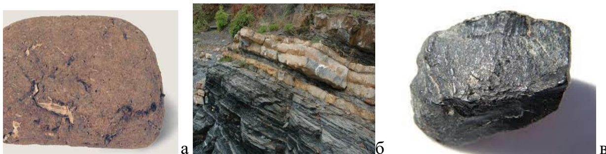
Рис. 2.2. Зразок а) торфу; б) горючих сланців; в) озокериту
