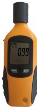
Рис .3.3. Світлина газоаналізатора ДОЗОР-С-П-СО [12]
