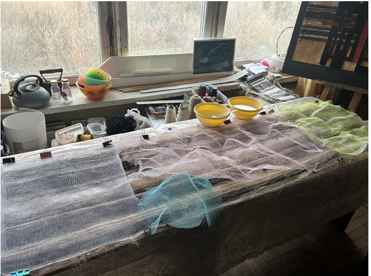
Рис. Е.2.16 Викладка пряжі на сітку перед клеєнням
