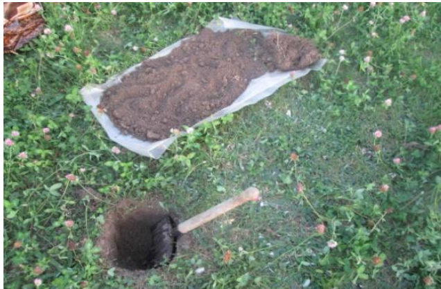
Рис. 3.1. Відбір зразків ґрунту
