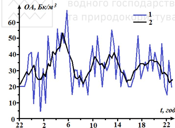
Рис. 3.16. Динаміка OA радону в повітрі приміщення (квартира, 1 поверх) протягом доби. 1 — значення OA ; 2 — середні значення OA за п'ятьма точками
