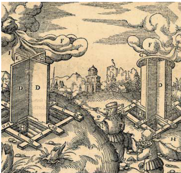
Рис. 4.1. Пасивна вентиляція шахт Шнеєберга (з гравюри Аґріколи)
