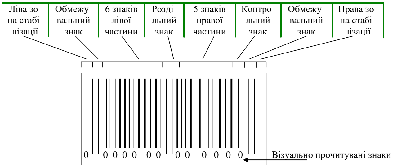
Рисунок 10.1 - Структура штрихового коду EAN-13
