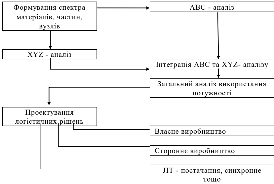
Рис.13. Блок-схема оптимізації вибору матеріалів, частин і вузлів
