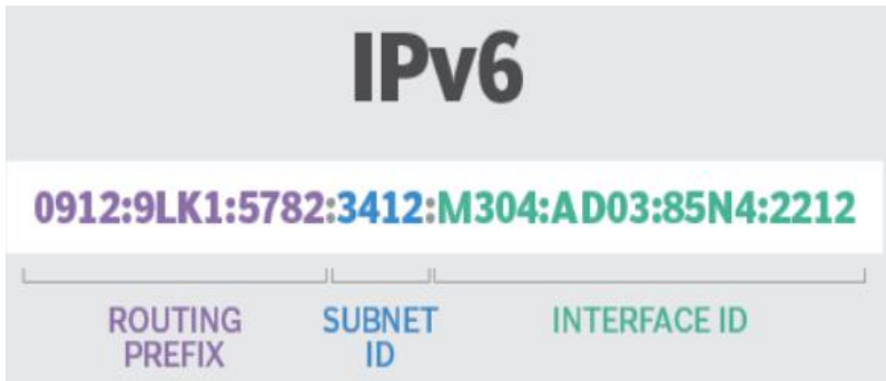
Рис. 5.2. Структура адреси IPv6
