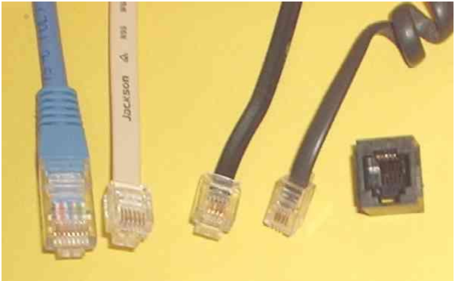
Рис. 7.1. Модульні штекерні роз'єми ліній зв'язку
