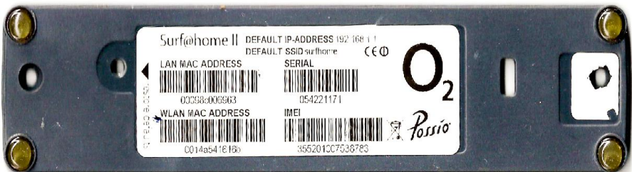
Рис. 6.1. Наклейка на маршрутизаторі з MAC-адресами модулів LAN і WLAN
