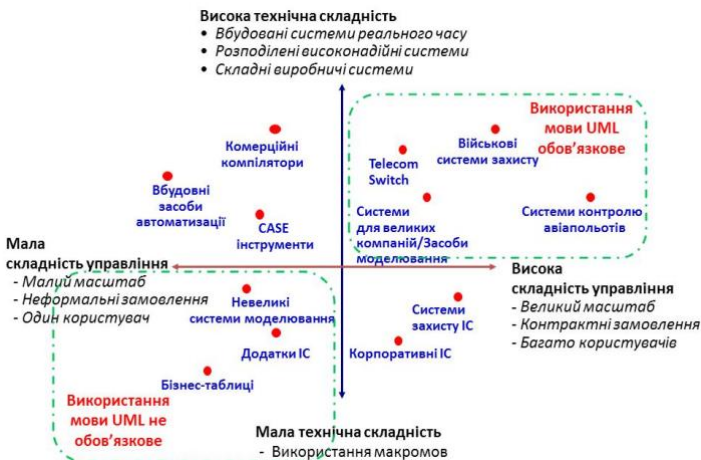
Рисунок 22 – Використання UML залежно від складності проекту
