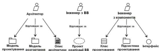
Рисунок 35 – Співробітники та артефакти моделі проектування Модель проектування розробляється відповідно до заданого порядку (рис.36):
