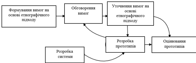
Рис. 2.17. Процес розробки вимог згідно до етнографічного підходу
