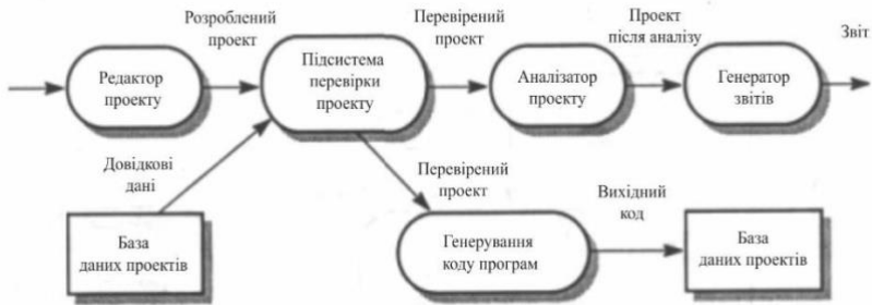
Рисунок 27 – Діаграма потоків даних комплексу CASE-засобів
