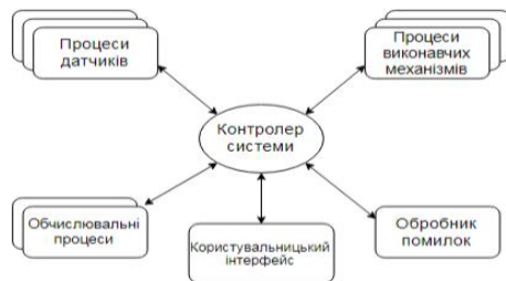
Рисунок 39 – Модель диспетчеру для системи реального часу
