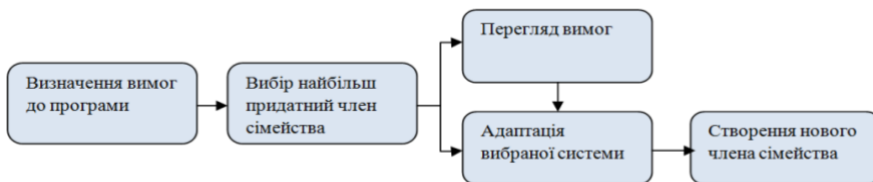
Рисунок 49 - Процес адаптації сімейства додатків
