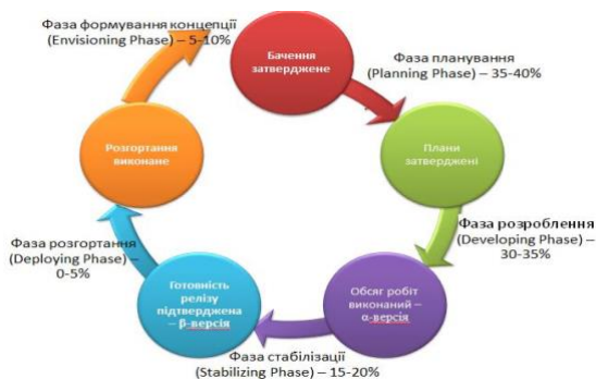
Рисунок 44 – Модель процесу (MSF Process Model)
