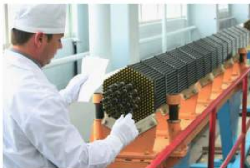
Рис.1.8. Тепловидільна збірка (ТВЗ) з трубками ТВЕЛ
