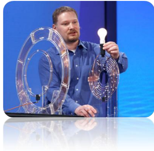
Рис. 2 Директор корпорації Intel із технологій Джастін Раттнер демонструє безпроводову передачу енергії)
