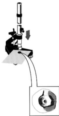
Рис. 3.4. Прилад типу У-1, У-2 для визначення міцності покриттів при ударі
