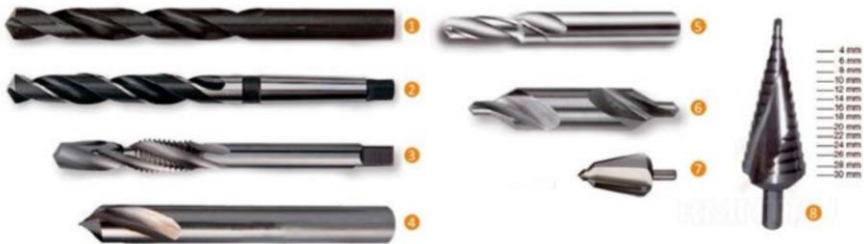
Рисунок 4.1 Види свердел: 1 – свердло із циліндричним хвостовиком; 2 – свердло з конічним хвостовиком; 3 – комбіноване свердло для нарізування внутрішньої різьби; 4 – центрувальне свердло; 5 – ступінчасте свердло; 6 – центрувальне свердло; 7 – конічне свердло; 8 – багатоступінчасте конічне свердло
