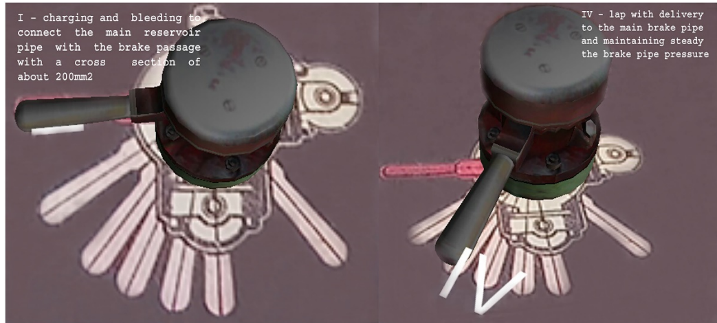
Рис. 2.7. Спосіб відображення стану гальмівного клапана водія з AR
