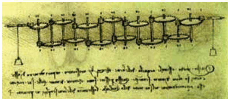
Рис. 1.1.2.25. Ескіз арифметичного пристрою Леонардо да Вінчі.
