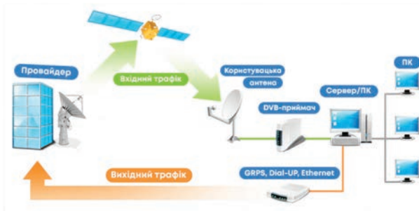
Рис. 1.3.29. Здійснення доступу до мереж через супутник.
