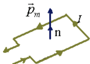
Рис. 1.2.2. Дія магнітного поля на провідник зі струмом.
