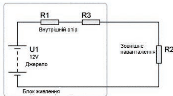
Рис. 1.2.38. Еквівалентна схема заміщення блоку живлення.
