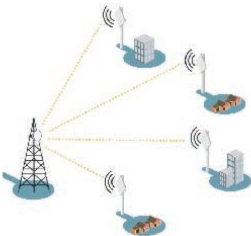
Рис. 1.3.28. Здійснення доступу до мереж через радіоканал.
