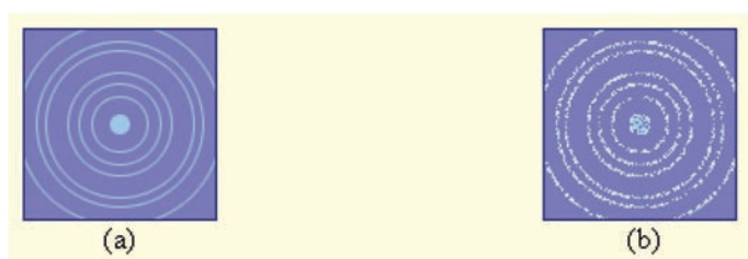
Рис. 1.5.2. Картина дифракції електронів на полікристалічному зразку при тривалій експозиції (а) та при короткій експозиції (б). У випадку (б) видно точки попадання окремих електронів на фотопластинку.
