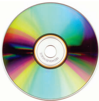
Рис. 1.2.16. Явище дифракції на поверхні компакт-диска.
