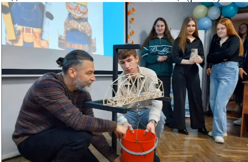
Рисунок 4 – Випробування моделі моста на міцність [2].
