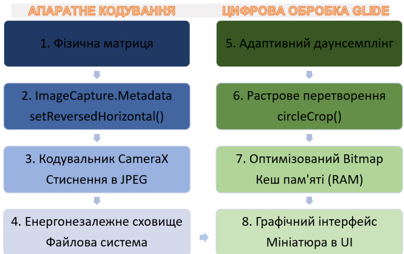
Рисунок 3.12. Схема конвеєра цифрової обробки зображення: від апаратного кодування до растрової трансформації.
