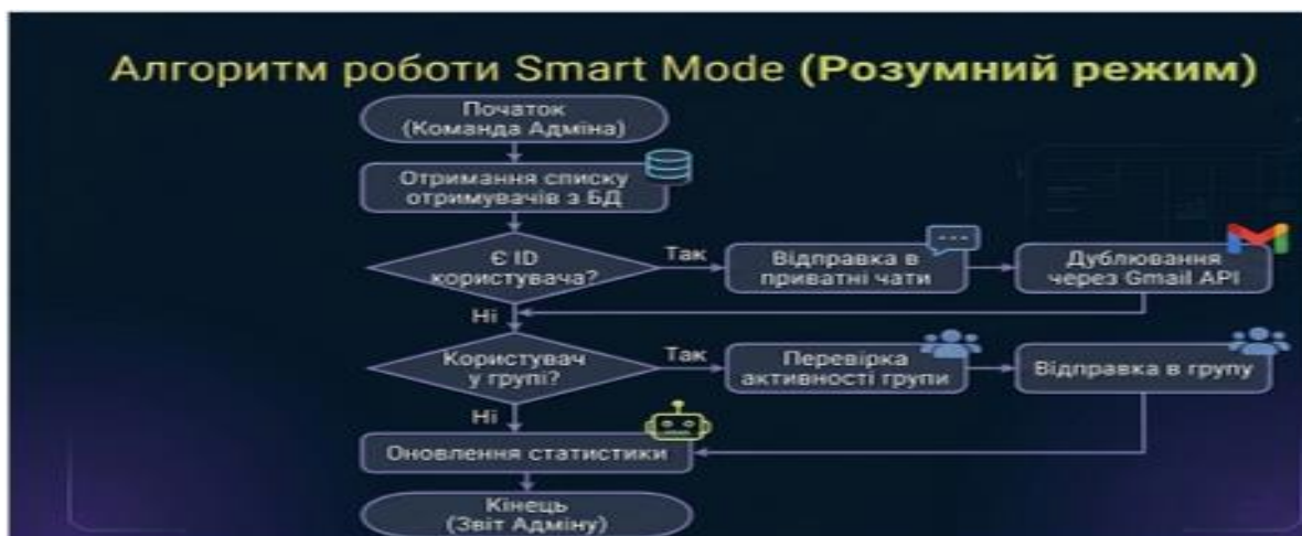
Рисунок. 3.2. Блок-схема алгоритму функціонування режиму «Smart Mode»
