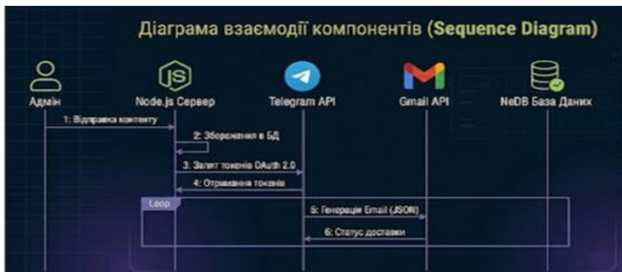
Рисунок 2.4. Діаграма послідовності асинхронного протоколу взаємодії компонентів системи при виконанні розсилки
