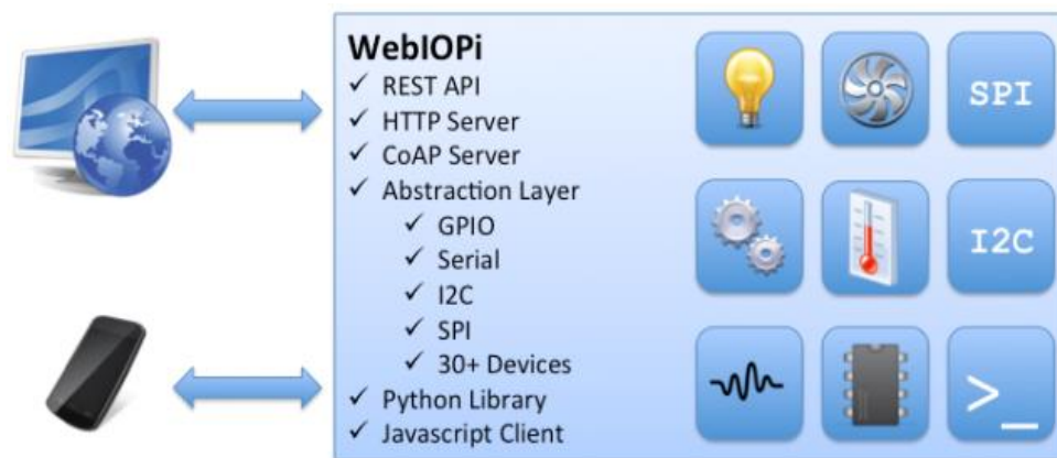
Рисунок 3.1. Схема управління контактною групою GPIO через вебінтерейс
