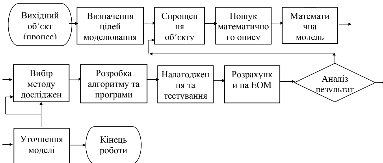
Етапи математичного моделювання за допомогою комп'ютера ([1])
