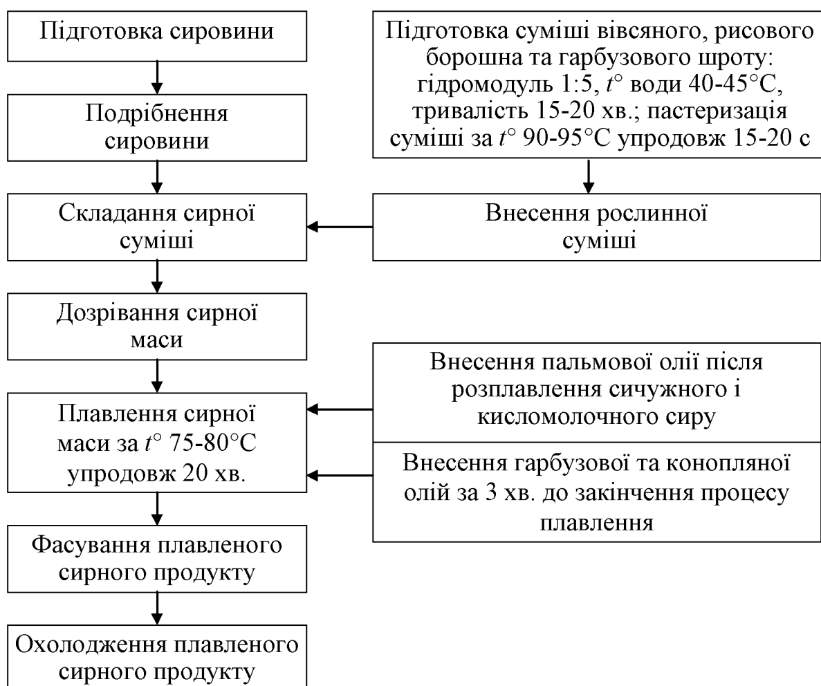
Рисунок 1 – Принципова технологічна схема виготовлення плавлених сирних продуктів із додаванням рослинної суміші і жирової композиції
