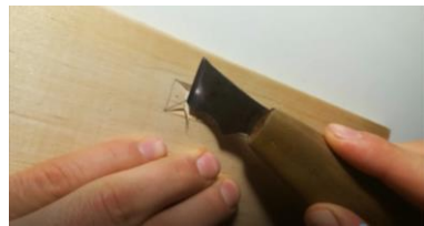
Рис. 4. Технологія виконання операції «підрізка» (фрагмент навчального відео)
