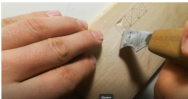
Рис. 3. Технологія виконання операції «надрізка» (фрагмент навчального відео)
